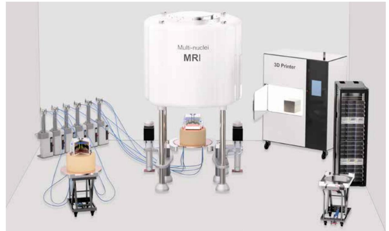
Eine Visualisierung des neu geplanten MRI-Labors: Geologische Reservoirs werden im 3D-Drucker (rechts) gedruckt, auf Experimentierwagen (links) vorbereitet und zur Messung ins MRI-Gerät (Mitte) geschoben.
