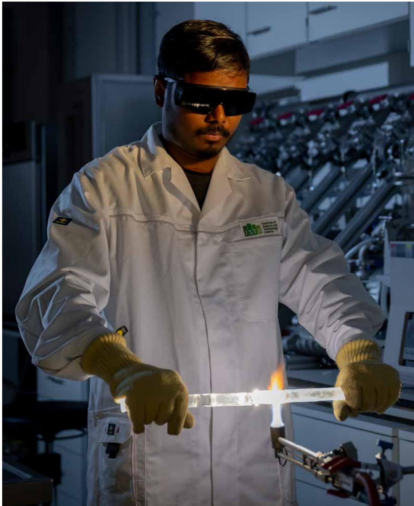
Um ein Reagenzglas zu formen, wird am WSS-Zentrum für thermoelektrische Materialien in Klosterneuburg bei Wien ein Glasstab geschmolzen.
