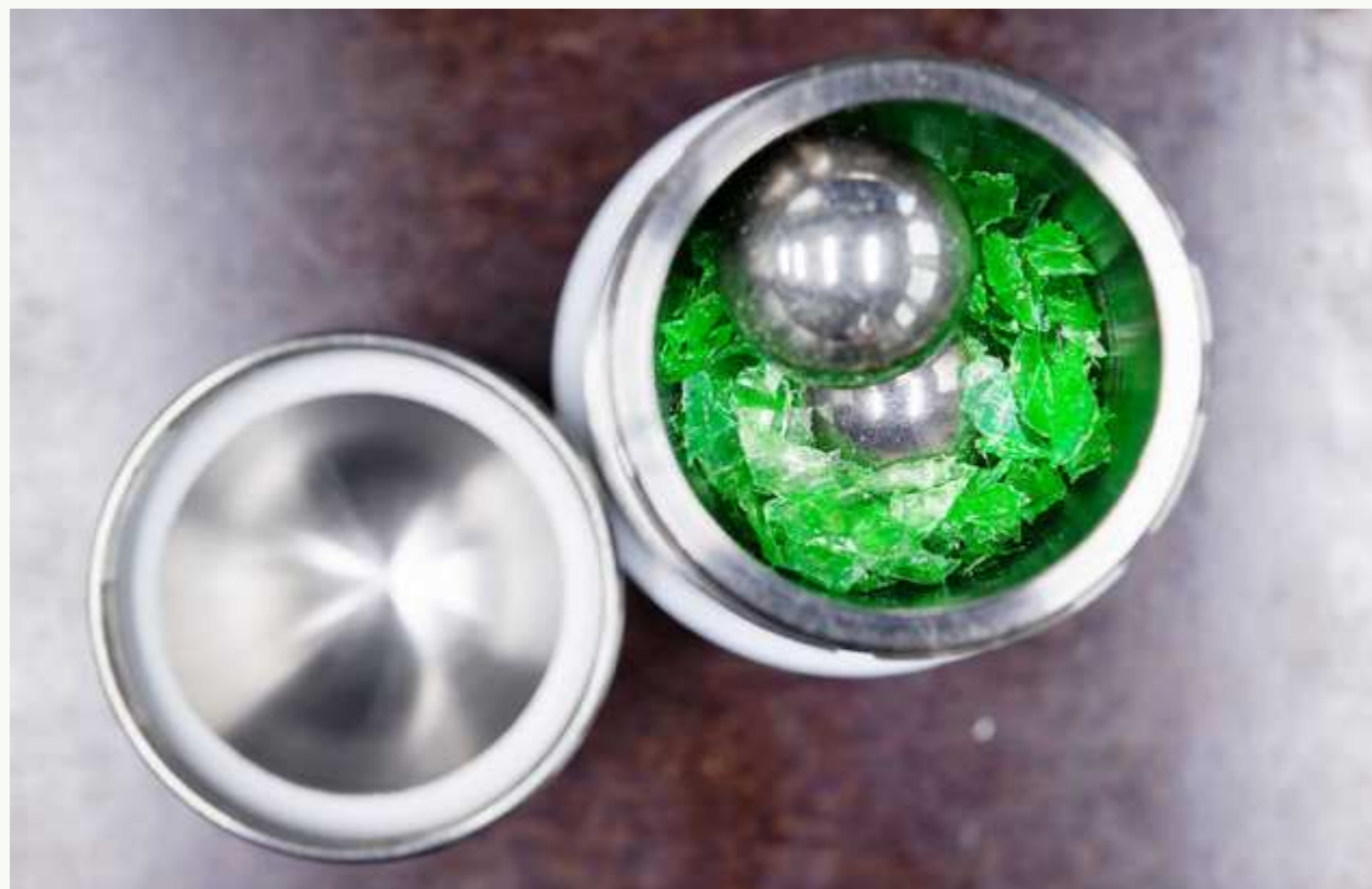
In der Laborkugel- oder Kryomühle werden Kunststoffe von zwei Kugeln zu einem Pulver zerstoßen. Um ein Schmelzen zu vermeiden, geschieht dies bei tiefen Temperaturen.
