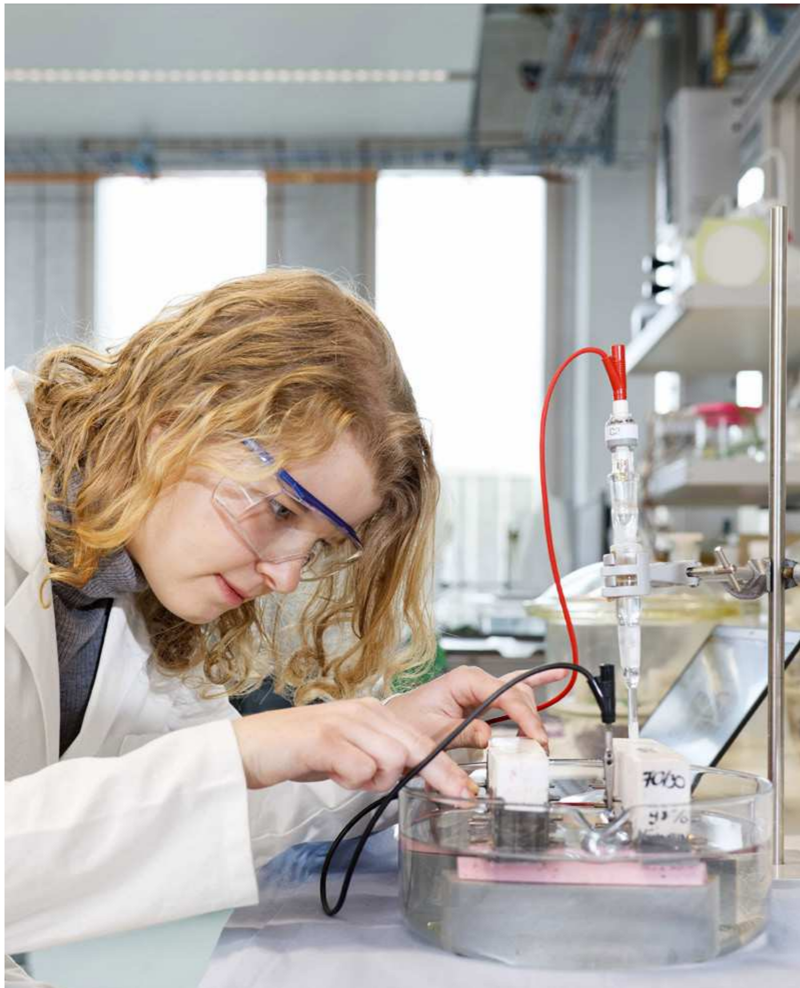
An kleinen Mörtelproben kommt die Forschungsgruppe von Ueli Angst an der ETH Zürich Korrosionsprozessen von Stahlbeton auf die Spur.
