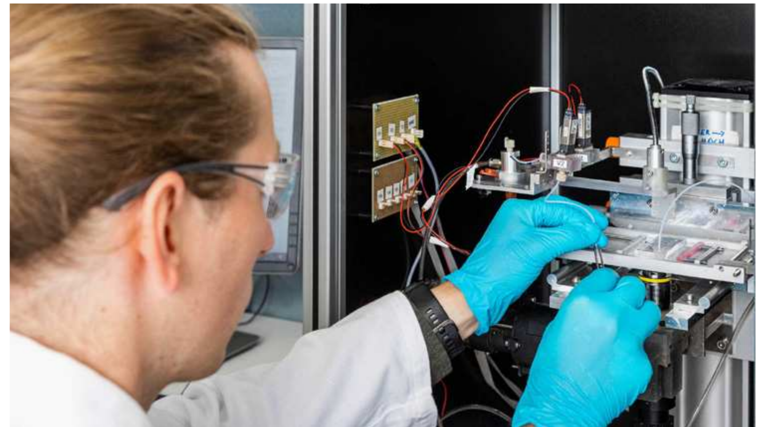
Mithilfe der Stop-Flow-Lithographie produzieren die Forschenden in Aachen Gel-Stäbchen, die bereits während des Vorgangs magnetisch ausgerichtet werden.
