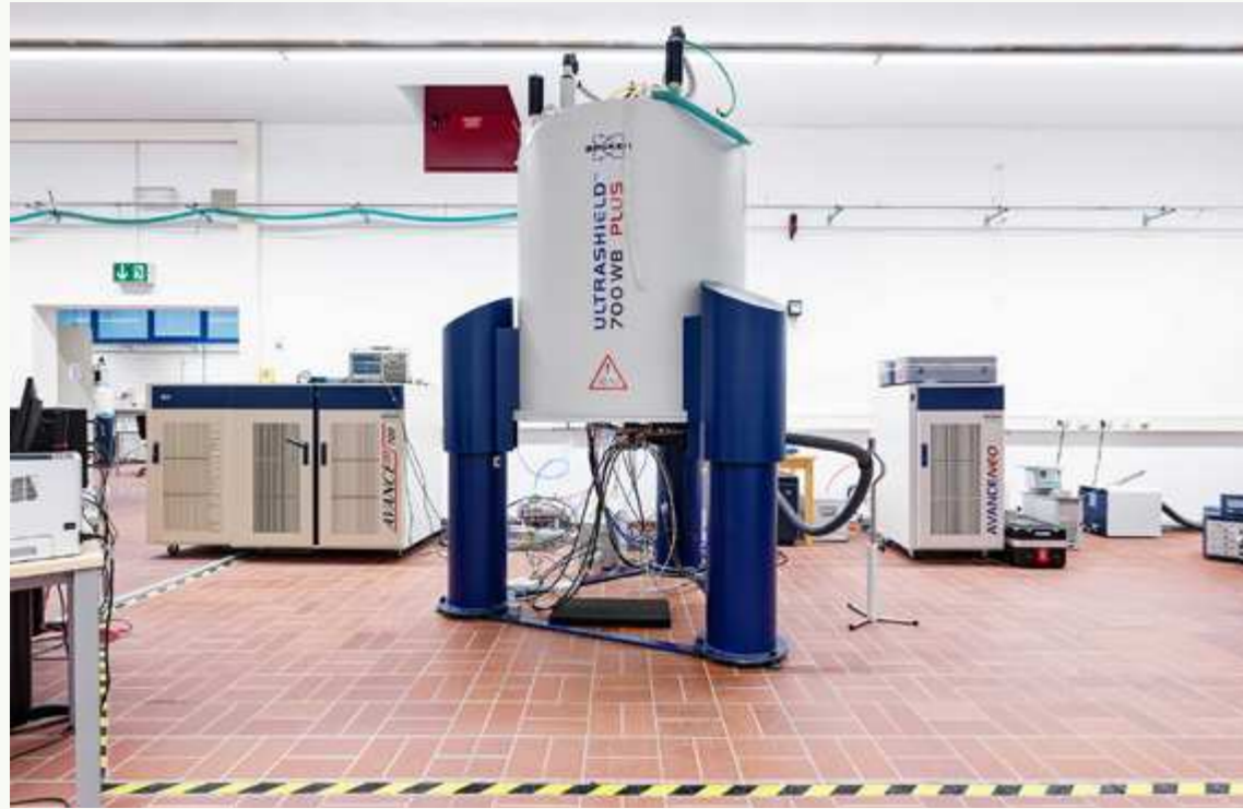
In Kernspinresonanzspektrometern lassen sich Moleküle genauestens untersuchen – oder gar chemische Reaktionen in Echtzeit «anschauen».
