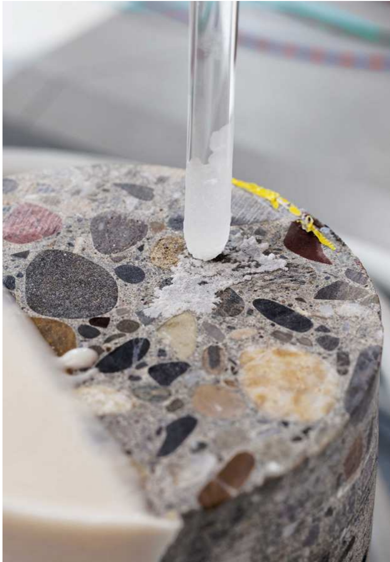
Durch das Aufsetzen einer Messprobe an der Oberfläche können Korrosionsprozesse im Betoninnern mitverfolgt werden.
