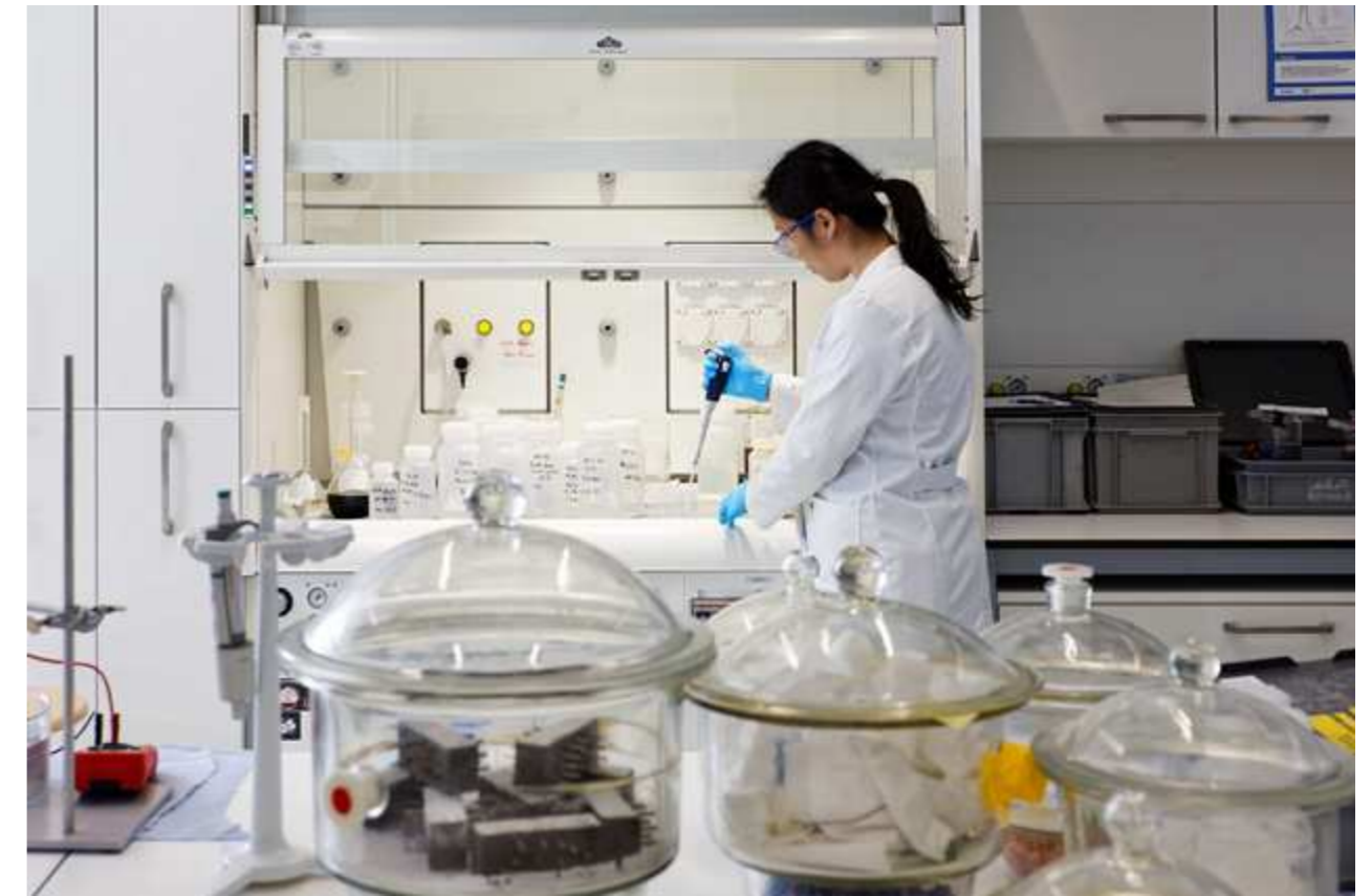
In Glasbehältern werden kleine Mörtelproben ganz bestimmten klimatischen Bedingungen ausgesetzt – und unter kontrollierten Bedingungen untersucht.
