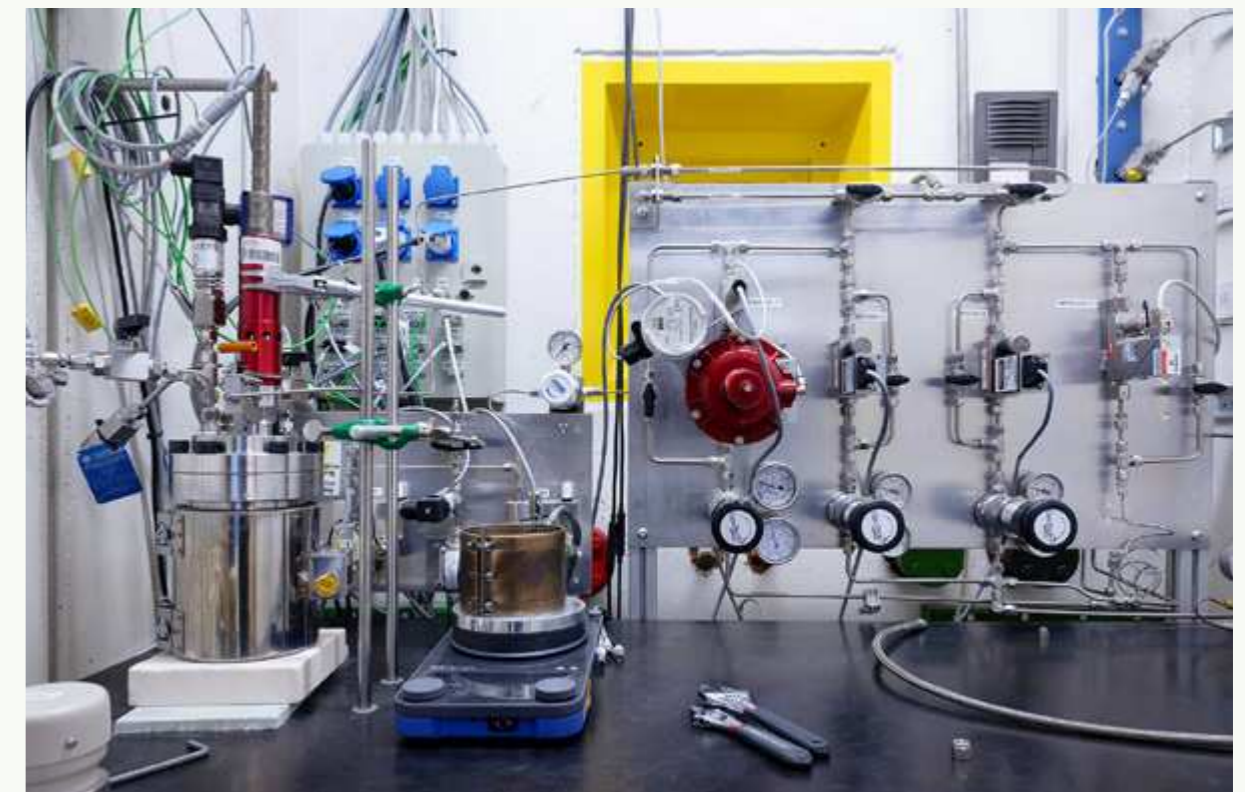
In diesem Versuchsreaktor in einer Hochdruckkammer wird Polyethylen unter Zugabe von Ethylen mit einer katalytischen Reaktion in den Grundbaustein Propen verkleinert.
